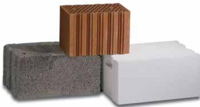
ны к трещинообразованию или отторжению. Причиной таких дефектов являются высокие теплоизолирующие свойства оснований из легкой кладки, их относительно низкий модуль упругости и незначительная прочность при сжатии в сочетании с высоким модулем упругости и прочности таких штукатурок и большой термической нагрузкой.
