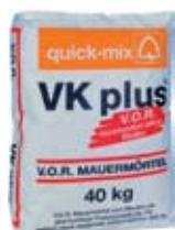
**VK plus** – гарантирует надежность системы благодаря тому, что раствор оптимально компенсирует специфические свойства экстремально абсорбирующего облицовочного камня с водопоглощением >10%, такого как кирпич ручной формовки, силикатный кирпич или сильно прогревающийся на солнце отделочный камень. Нет ни чрезмерного высыхания, ни «сгорания» раствора в местах соприкосновения. Высокая прочность сцепления с основанием даже без предварительного смачивания камня и водонепроницаемость в ливень.
