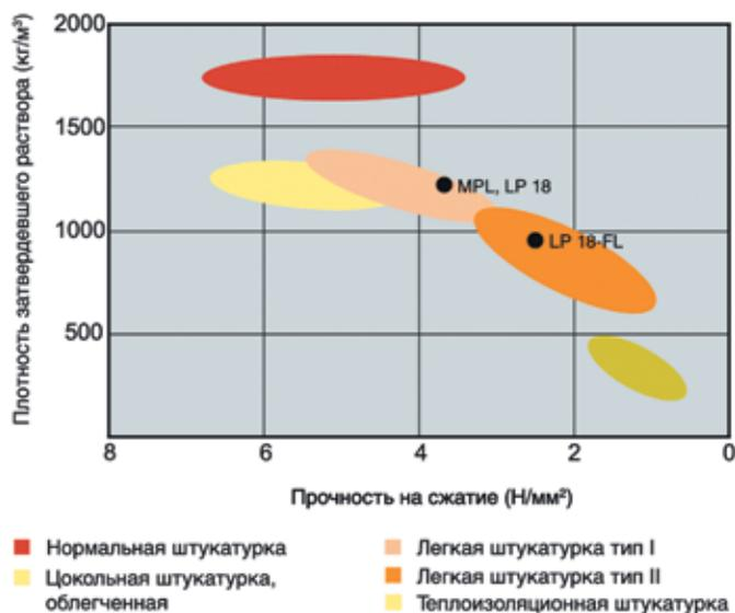
Данная схема демонстрирует показатели легких штукатурок quick-mix I и II типов по сравнению с другими штукатурками, исходя из плотности затвердевшего раствора и прочности на сжатие:
