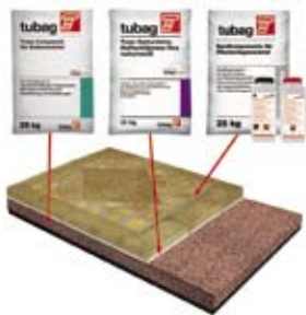
Водопроницаемые швы. Укладка на готовую водонепроницаемую основу
