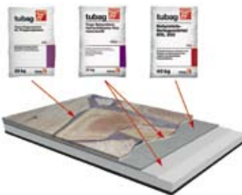
Водонепроницаемые швы. Укладка на бетонную основу (по необходимости гидроизоляция)
