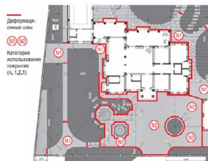
Рис 1.2 (д). Пример расположения температурных и деформационных швов при мощении территории индивидуального частного участка
