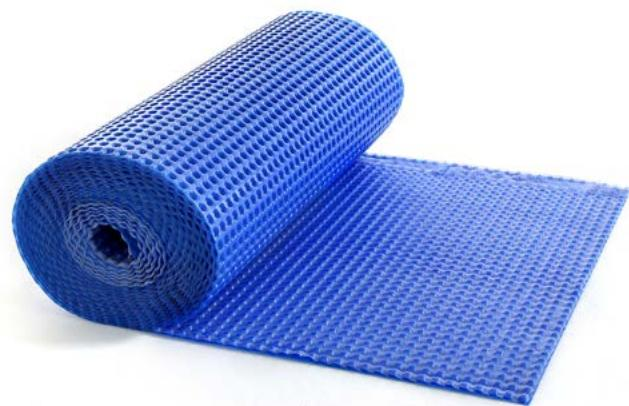
Дренажный мат TK-NET – это геокомпозит, выполненный из полиэтилена высокой плотности с термически прикрепленной сеткой. Дренажный мат TK-NET укладывают на гидроизолированную бетонную плиту, чтобы обеспечить быстрое отведение воды из-под мощения. Техническое описание мата TK-NET можно посмотреть на нашем сайте:
