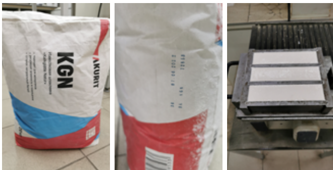
akurit KGN Известковая шпаклевка, изготовление образцов
