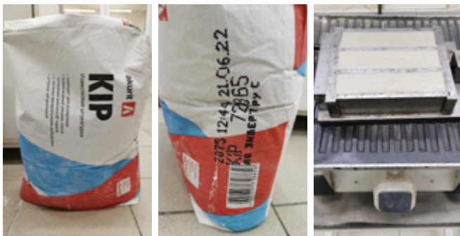
akurit KIP Известковая штукатурка, изготовление образцов
