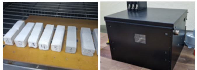
образцы akurit KIP и akurit KGN до испытаний
